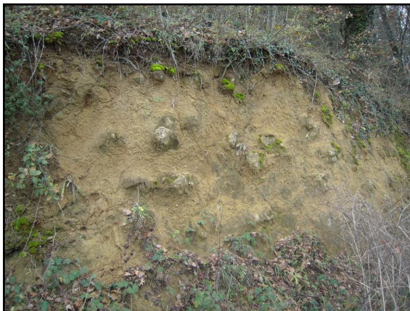
Fig. 4 – Arenarie e sabbie stratificate della Formazione del Flysch del Molise, appartenenti alla sottoclasse ALS (b) del substrato, costituito da un’Alternanza di Litotipi Stratificati, in un affioramento nei pressi dell’abitato di Taverna.
