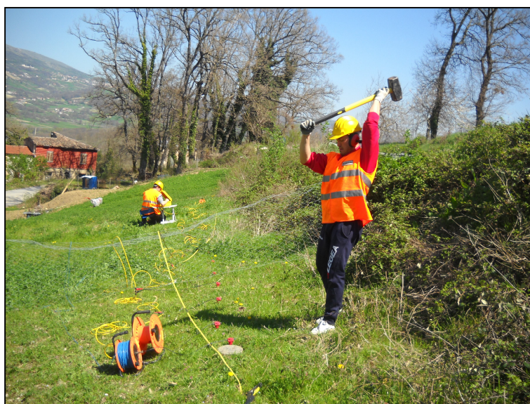
FOTO 2: esecuzione del momento di energizzazione.
